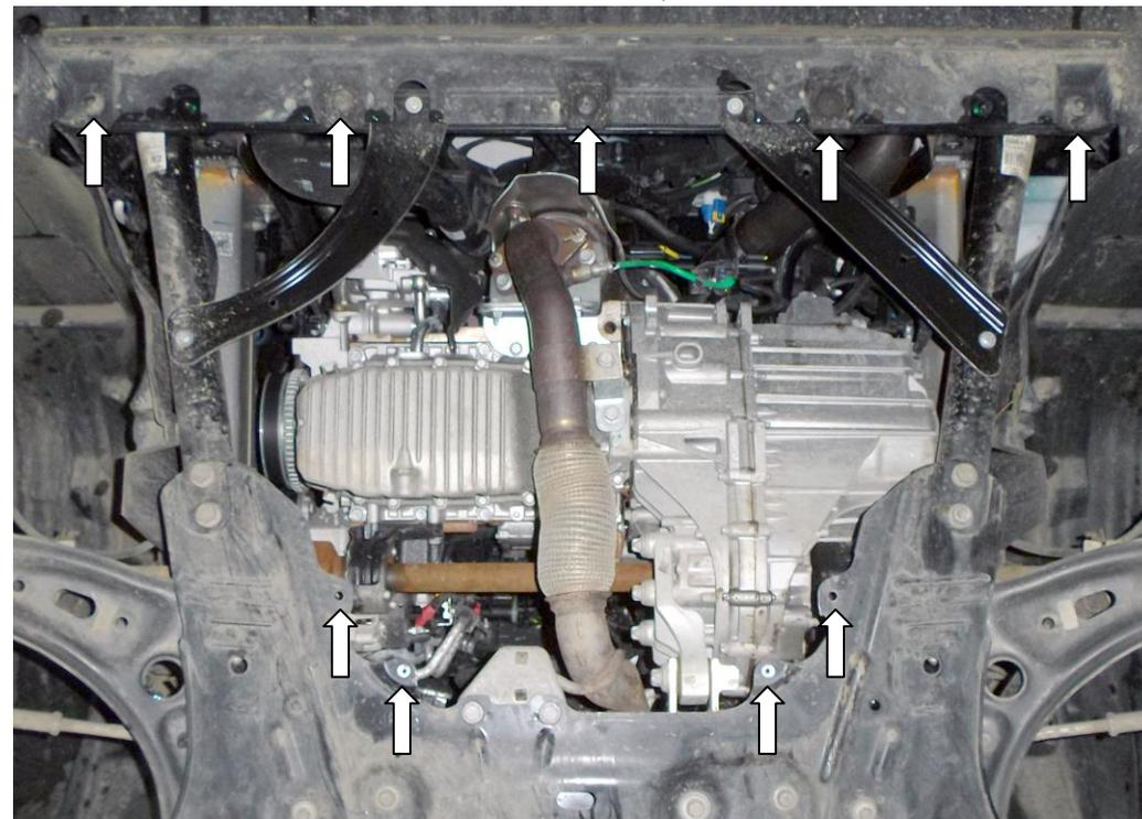
1. Снять штатный пыльник.
